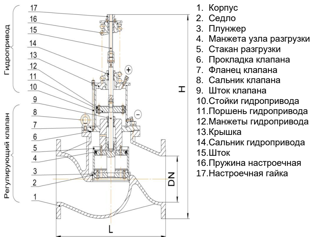
Рис.7 Регулятор УРД–НО DN 250-300
